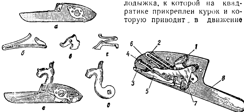
Рис. 6. Подкладной замок куркового ружья:
